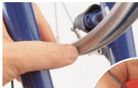
**3** Weil sich Speichen lediglich selbsttätig lösen, aber niemals selbst spannen können, beheben Sie fast alle **SEITENSCHLÄGE**, indem Sie diejenige(n) Speiche(n) auf der gegenüberliegenden Seite der „Ausbeulung“ suchen, die eine geringere Spannung als die anderen der gleichen Seite aufweisen. Spannen Sie nur diese losen Speichen in kleinen Schritten von jeweils einer Viertelumdrehung nach.
