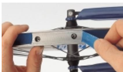
**5** Der beste **PANNENSCHUTZ**: ein gutes Felgenband. In Frage kommen nur solche aus festem Kunststoff (von Michelin oder Schwalbe) oder geklebte Gewebebänder (Conti, Ritchey, Vellox). Gucken Sie regelmäßig unter das Band, um die Felge auf Risse im Reifenbett zu checken. Auch diese können zum Felgenplatzer führen.
